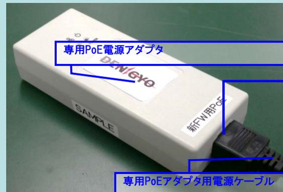
⑨「PoEインジェクタ」と「ACケーブル」を接続します。また、「ACケーブル」を電源コンセントに接続します。
