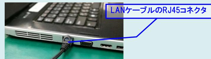
⑬「LANケーブル」の反対側のRJ45コネクタをPC等の機器に接続します。
