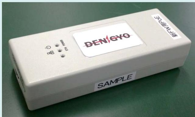
⑩「FalconWAVE4.9G-MP」には電源スイッチがありません。PoE(Power over Ethernet)を利用し、ネットワークケーブルより電力を供給することで動作します。
