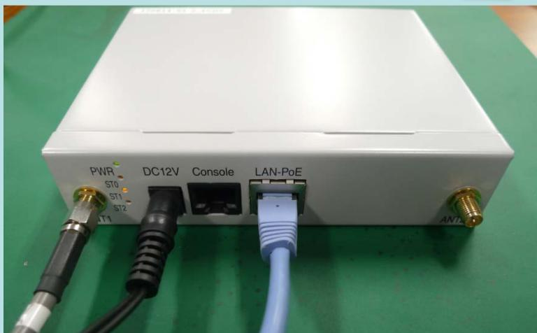
⑪同軸ケーブルとNJ-SMAJ(R)変換ケーブルを接続します。
