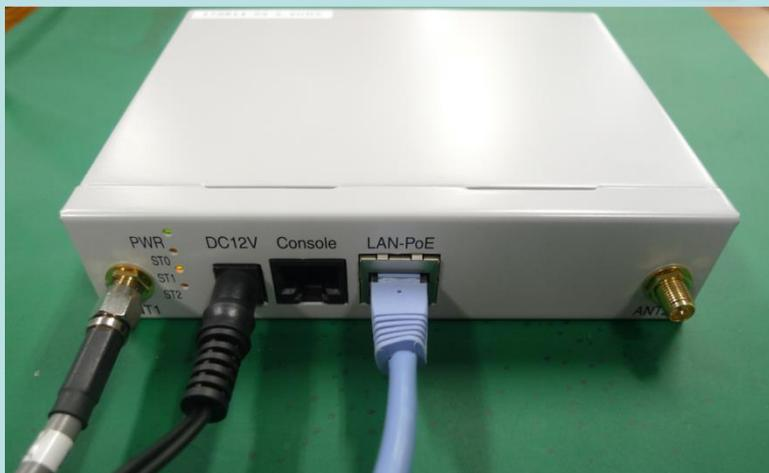
⑫本体の「LAN-PoE」ポートにLANケーブルを接続、「DC12V」ポートにACアダプタを接続します。
