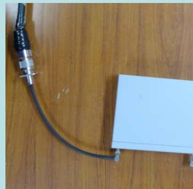
⑪同軸ケーブルとNJ-SMAJ(R)変換ケーブルを接続します。
