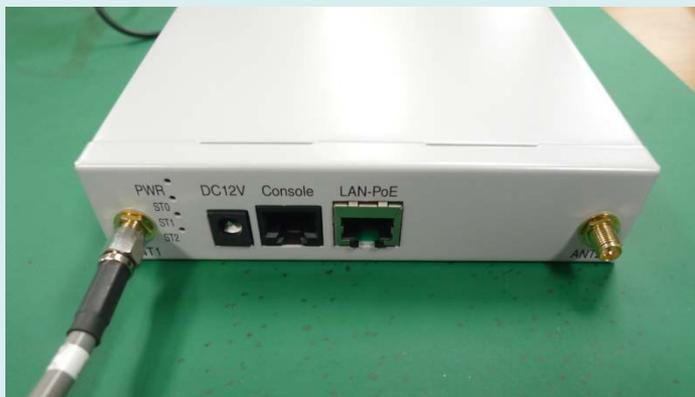
⑩「ANT1」または「ANT2」ポートにNJ-SMAJ(R)変換ケーブルを接続します。※デフォルト設定では「ANT1」を使用します。
