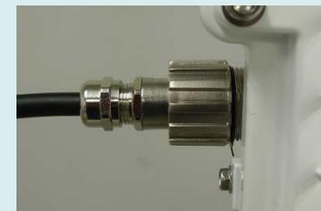
⑯GE1/PoEコネクタに「RJ45防水ケーブル」の丸コネクタ側を接続します。
