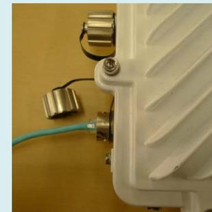
「LANケーブル」の反対側のRJ45コネクタを「FalconWAVE-FAST」の「GE1/PoE」ポートに接続します。
