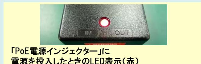
①「PoE電源インジェクター」と「PoE電源インジェクター用電源ケーブル」を接続し、「PoE電源インジェクター用電源ケーブル」を電源コンセントに接続します。
