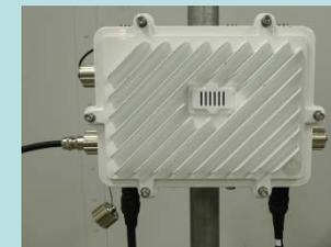
⑰「同軸アンテナケーブル」に「自己融着テープ」、「耐候性ビニルテープ」で防水テーピングを実施します。(詳細手順は⑤～⑧参照)
